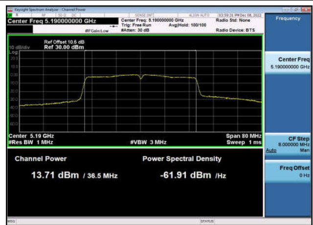
U-NII-1 Output Power-802.11ac(40MHz) ,5190MHz,Ant1
