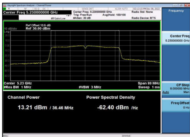
U-NII-1 Output Power-802.11n(40MHz) ,5230MHz,Ant1
