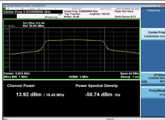
U-NII-3 Output Power-802.11ac(40MHz) ,5795MHz,Ant1
