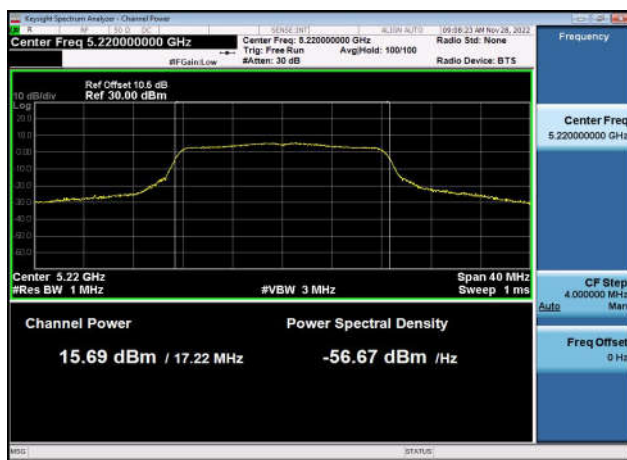
U-NII-1 Output Power-802.11ac(20MHz) ,5180MHz,Ant1
