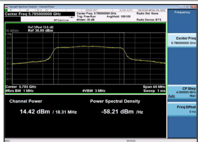
U-NII-3 Output Power-802.11ac(20MHz) ,5785MHz,Ant1
