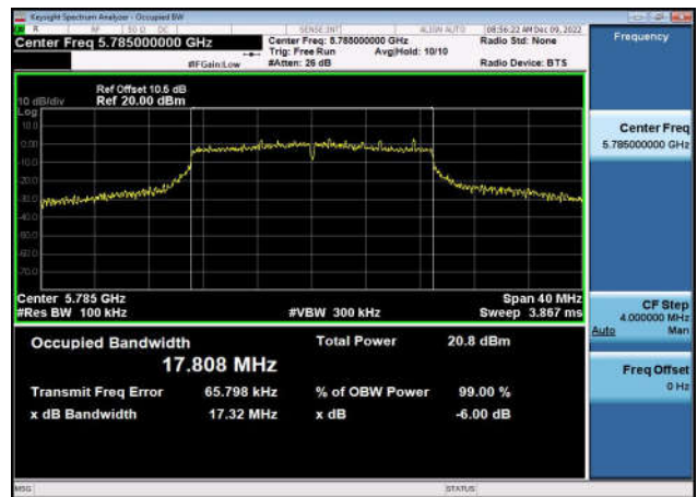
U-NII-3 6dB Bandwidth-802.11n(40MHz) ,5755MHz,Ant1
