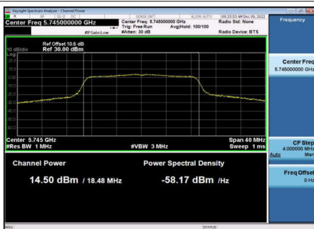
U-NII-3 Output Power-802.11ac(20MHz) ,5745MHz,Ant1
