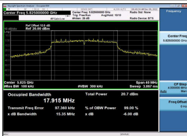
U-NII-3 6dB Bandwidth-802.11ac(20MHz) ,5825MHz,Ant1
