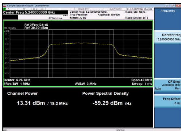
U-NII-1 Output Power-802.11n(40MHz) ,5230MHz,Ant1
