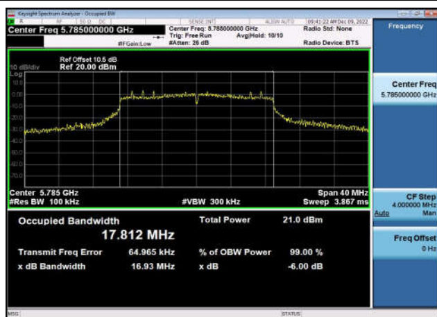
U-NII-3 6dB Bandwidth-802.11ac(40MHz) ,5755MHz,Ant1
