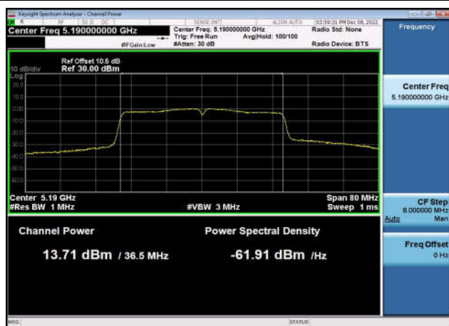
U-NII-1 Output Power-802.11ac(40MHz) ,5190MHz,Ant1
