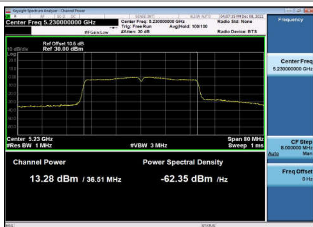
U-NII-3 Output Power-802.11n(20MHz) ,5745MHz,Ant1
