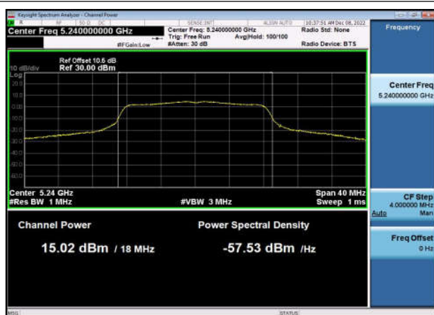
U-NII-1 Output Power-802.11ac(20MHz) ,5220MHz,Ant1
