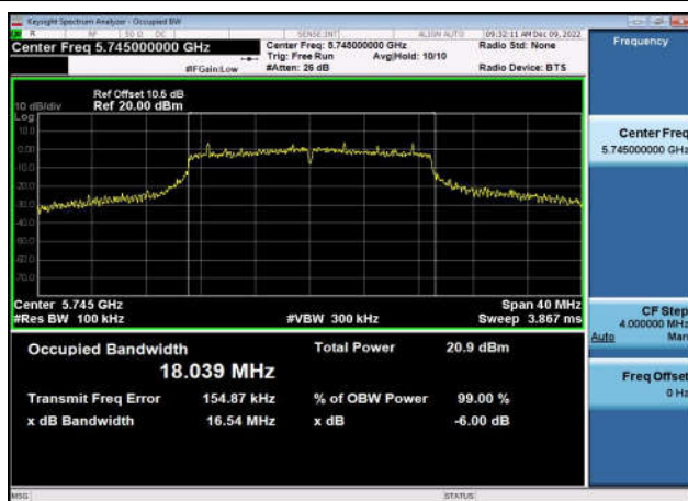
U-NII-3 6dB Bandwidth-802.11ac(20MHz) ,5825MHz,Ant1
