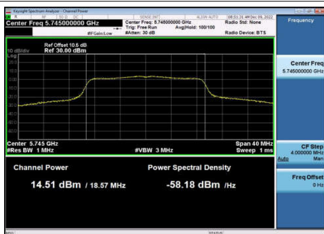
U-NII-3 Output Power-802.11n(20MHz) ,5825MHz,Ant1
