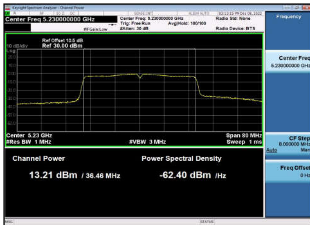
U-NII-1 Output Power-802.11n(40MHz) ,5230MHz,Ant1
