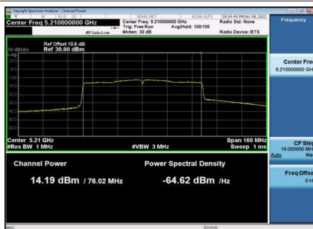
U-NII-3 Output Power-802.11n(20MHz) ,5785MHz,Ant1
