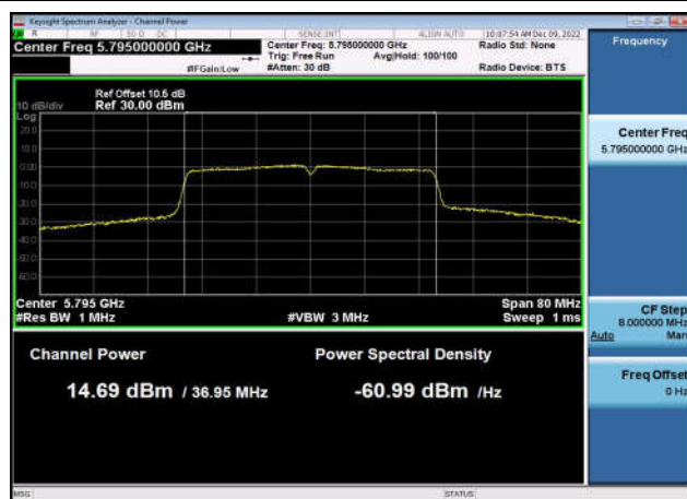
U-NII-3 Output Power-802.11ac(40MHz) ,5795MHz,Ant1
