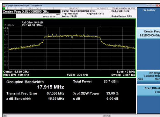
U-NII-3 6dB Bandwidth-802.11ac(20MHz) ,5825MHz,Ant1
