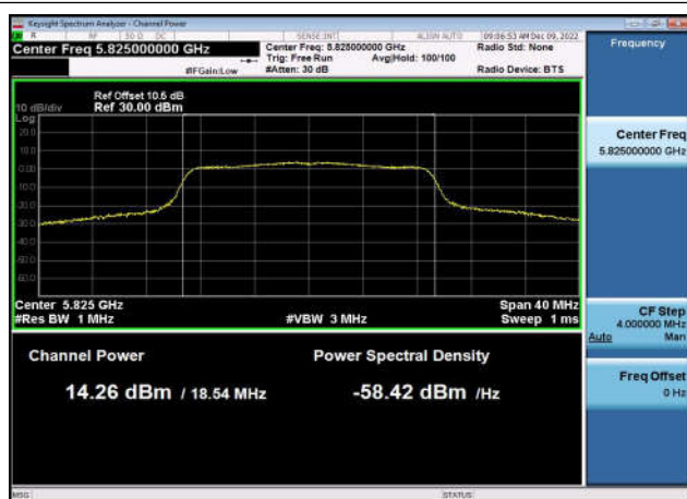
U-NII-3 Output Power-802.11n(20MHz) ,5825MHz,Ant1
