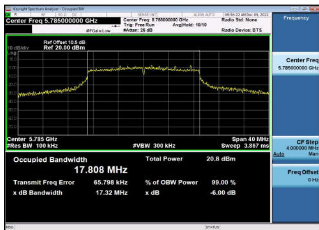
U-NII-3 6dB Bandwidth-802.11n(40MHz) ,5755MHz,Ant1
