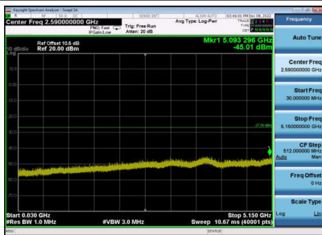
U-NII-1 ,Plot 2,30MHz~5150MHz-802.11a c(20MHz),5240MHz,Ant1
