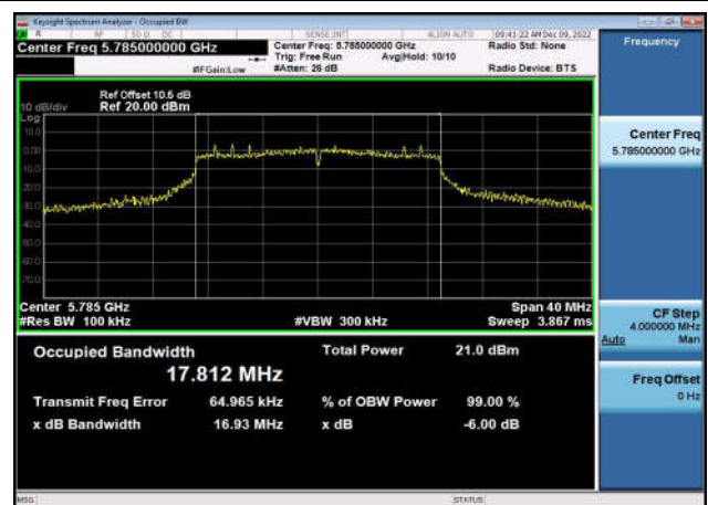
U-NII-3 6dB Bandwidth-802.11ac(40MHz) ,5755MHz,Ant1
