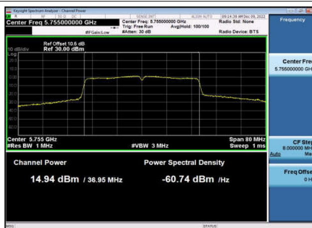
U-NII-3 Output Power-802.11n(40MHz) ,5755MHz,Ant1
