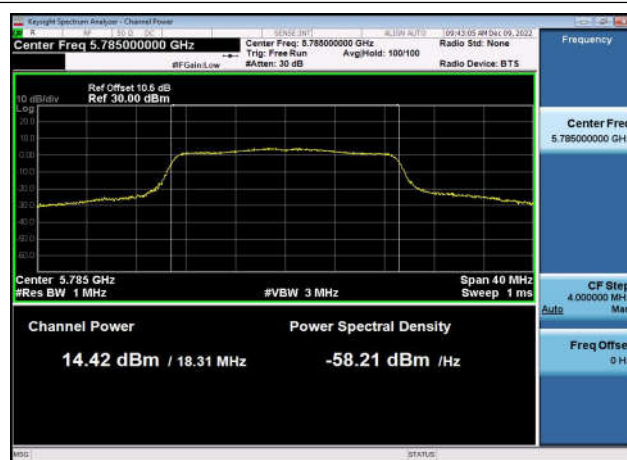
U-NII-3 Output Power-802.11ac(20MHz) ,5785MHz,Ant1
