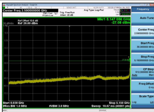
U-NII-1 ,Plot 2,30MHz~5150MHz-802.11a c(20MHz),5240MHz,Ant1
