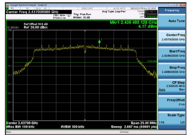
,Plot 2,Band Edge-802.11n(HT20) ,2412MHz,Ant0
