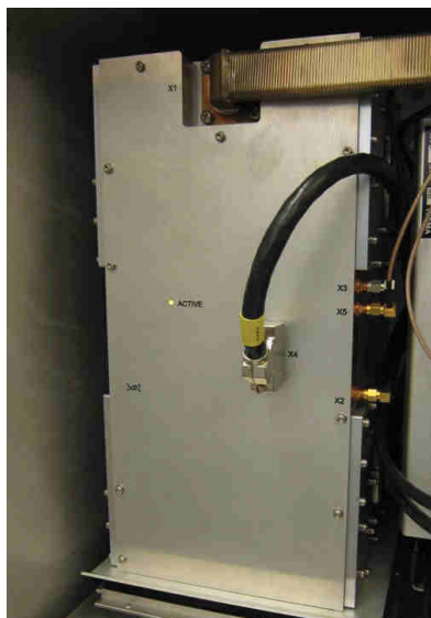
Fig. 4.6 SCANTER 5102/5202 SSPA module - 4 x 50 W PA modules
