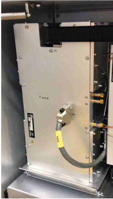
Fig. 5.7 SCANTER 6002 SSPA module - 4 x 50 W PA modules
