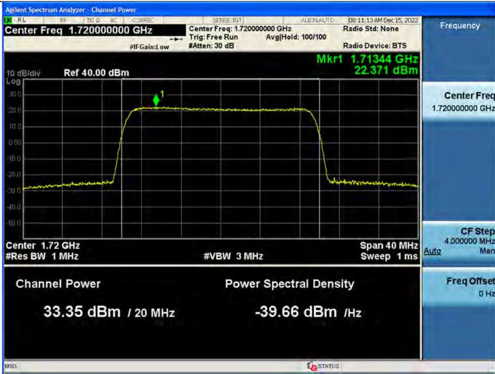
PSD / AWS / Uplink / 5G NR 20 MHz
