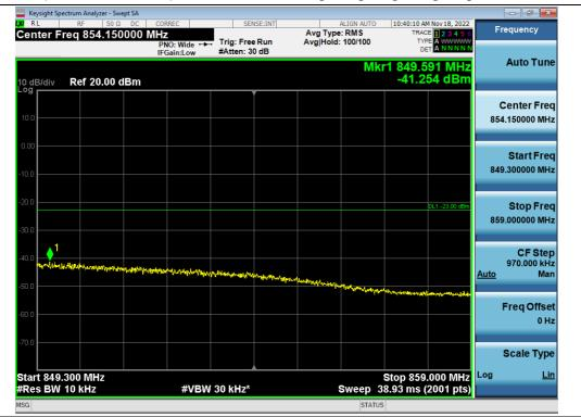
Spurious / Cellular / Uplink / 5G NR 20 MHz / High / High Edge ~ High Edge + 10 MHz
