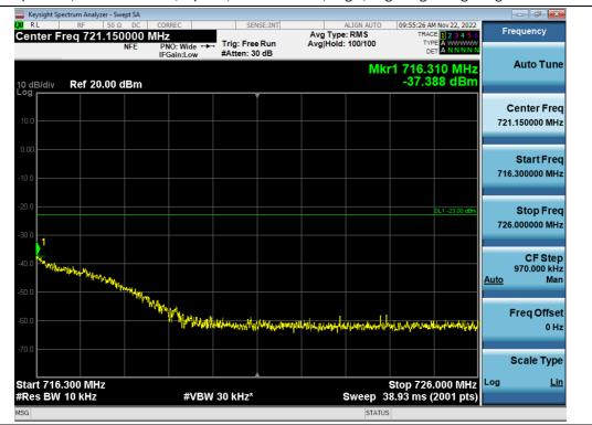
Spurious / Lower 700 MHz / Uplink / 5G NR 10 MHz / High / High Edge ~ High Edge + 10 MHz
