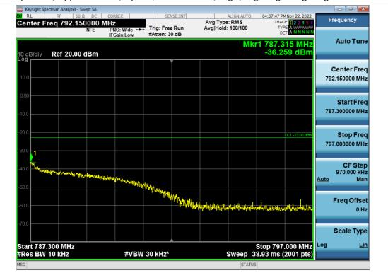
Spurious / Upper 700 MHz / Uplink / 5G NR 10 MHz / High / High Edge ~ High Edge + 10 MHz
