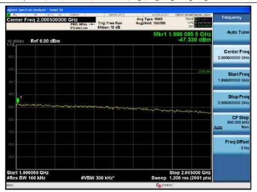
Spurious / PCS / Downlink / LTE 20 MHz / High / High Edge ~ High Edge + 10 MHz
