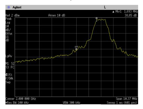
Band Edge 2483.5 MHz Tuned Freq = 2480 MHz
