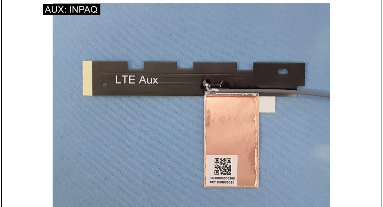
EUT Photo (30) WWAN antenna AUX : INPAQ
