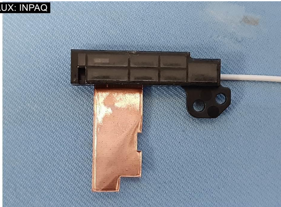
EUT Photo (24) WLAN antenna AUX : INPAQ
