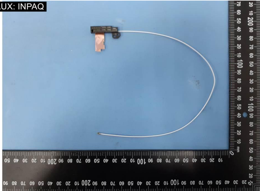
EUT Photo (24) WLAN antenna AUX : INPAQ
