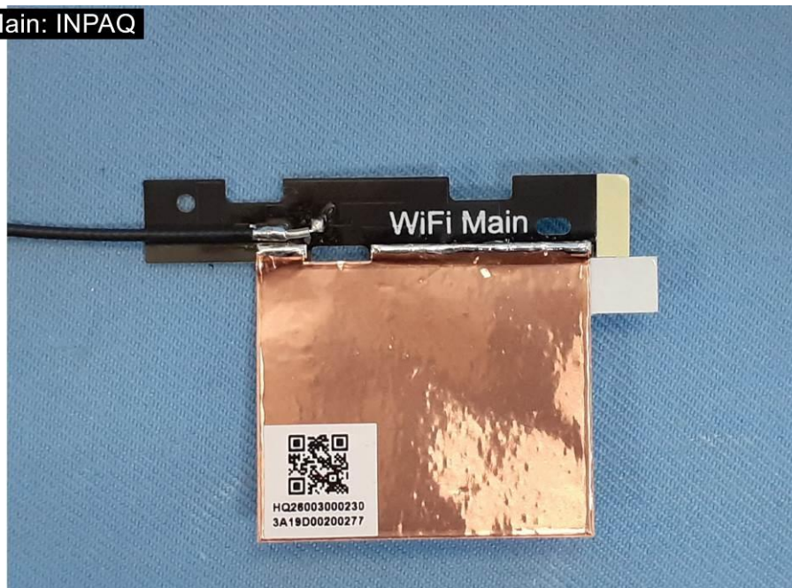
EUT Photo (18) WLAN antenna Main : INPAQ
