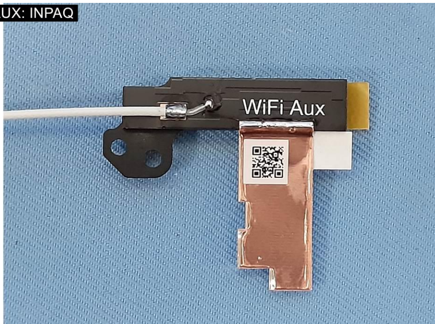
EUT Photo (22) WLAN antenna AUX : INPAQ
