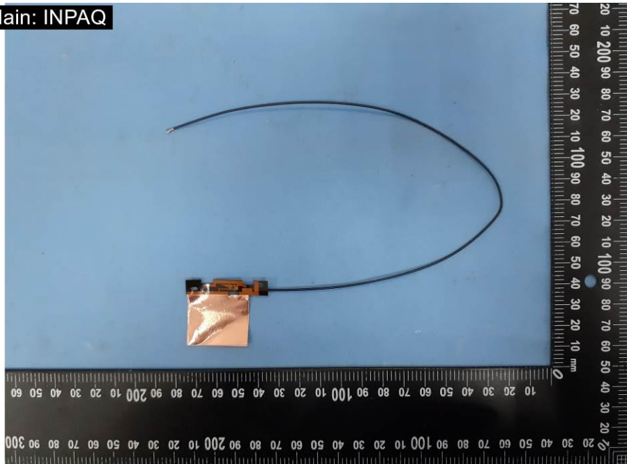
EUT Photo (20) WLAN antenna Main : INPAQ
