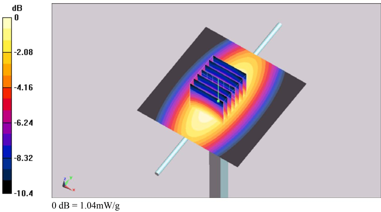
**System Check\_1900MHz\_100212****DUT: Dipole 1900 MHz**
