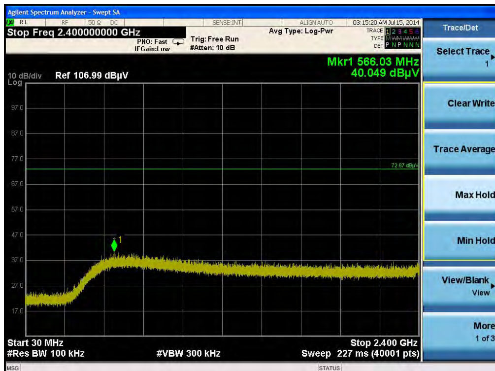
Plot on Configuration IEEE 802.11ac MCS0/Nss1 VHT20 / CH 11 / 30MHz~2400MHz (down 30dBc)
