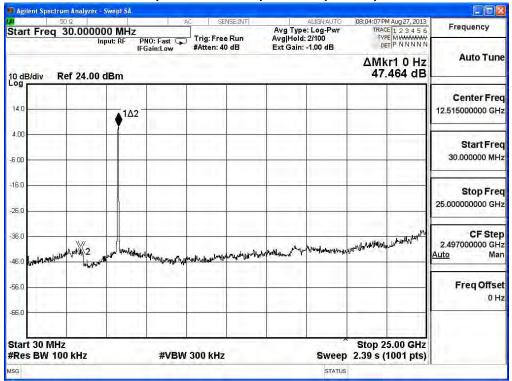
5795MHz (30MHz~25GHz) -802.11n(40MHz)-ANT 2
