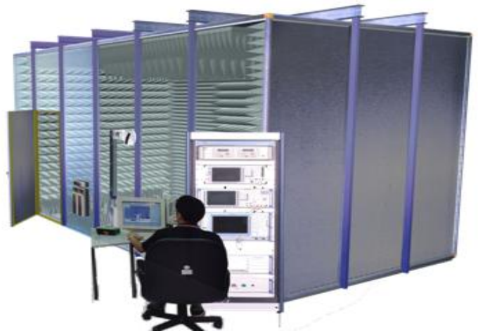
Agilent 网络分析仪 ETS AMS 8500 OTA Chamber
