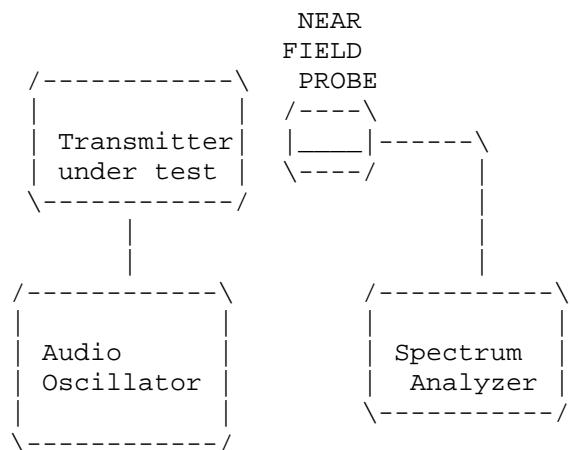
REQUIREMENT: PART 90.217 EMISSION BANDWIDTH PLUS FREQUENCY STABILITY <40KHz AT 30dB.
