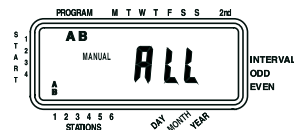
Ilustración 10: Riego semiautomático para las estaciones asignadas a los programas A y B
