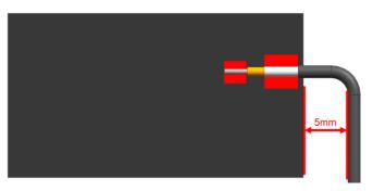
**FIGURE 5.2.1 CABLE BENDING**
