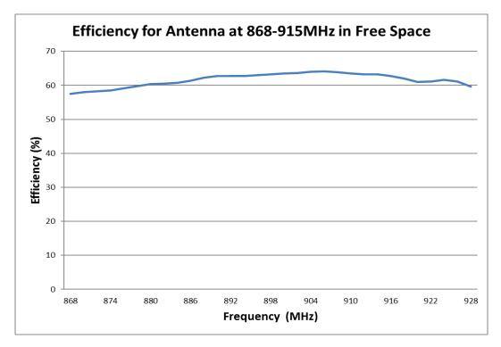
FIGURE 4.4.1 EFFICIENCY OF ANTENNA AT 868/915MHZ IN FREE SPACE
