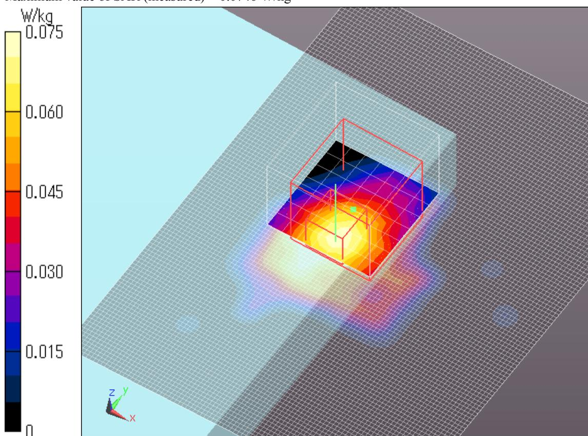
**WLAN Aux ant 11a 6Mbps 5240MHz Edge1 tilt 0mm**
