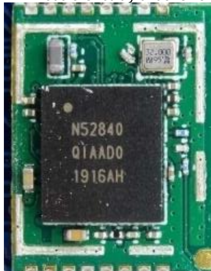
BLE Module Circuitry under shield
