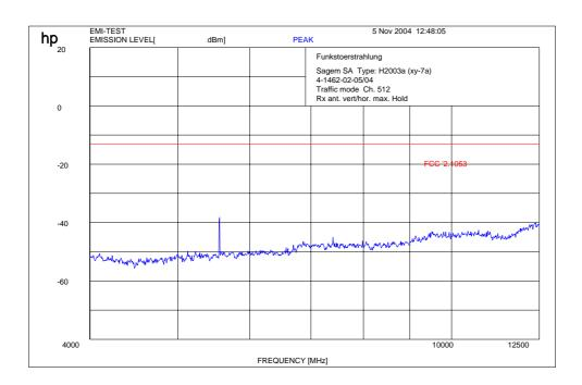
$f < 1 \; GHz : RBW/VBW : 100 \; kHz \\ \hspace*{1.5cm} f \geq 1GHz : RBW \; / \; VBW \; 1 \; MHz$
