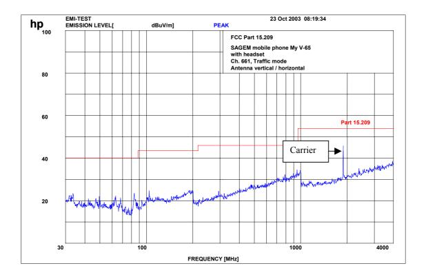
$f < 1 \text{ GHz} : RBW/VBW} : 100 \text{ kHz}$   $f \ge 1 \text{ GHz} : RBW/VBW} 1 \text{ MHz}$
