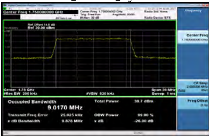
Band4 10MHz_QPSK 50 0_HighCH20350-1750
