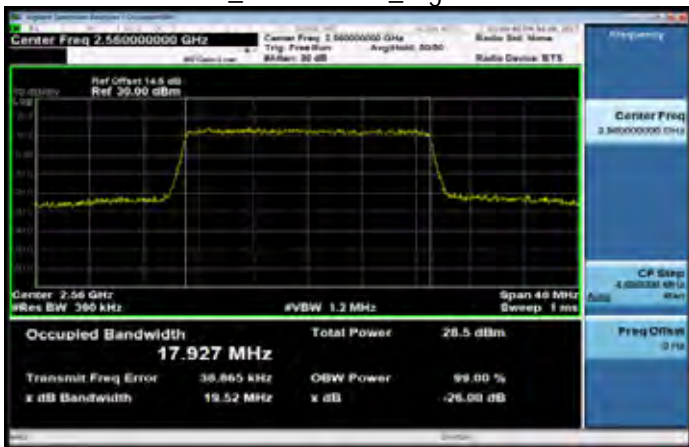
Band7 20MHz_QPSK 100 0_HighCH21350-2560
