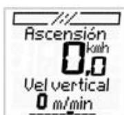
El prorrateo de la pendiente le muestra la velocidad vertical actual en metros por minutos. Así puede calcular rápidamente el tiempo necesario para alcanzar la cima. Aquí se trata de una función actual similar a la de la velocidad.
