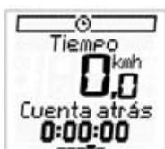
El cronómetro se inicia o se detiene con las teclas superiores derechas. Con la tecla izquierda puede volver el cronómetro a 0. El cronómetro funciona independientemente del tiempo de marcha y por lo tanto debe iniciarse/detenerse manualmente.
