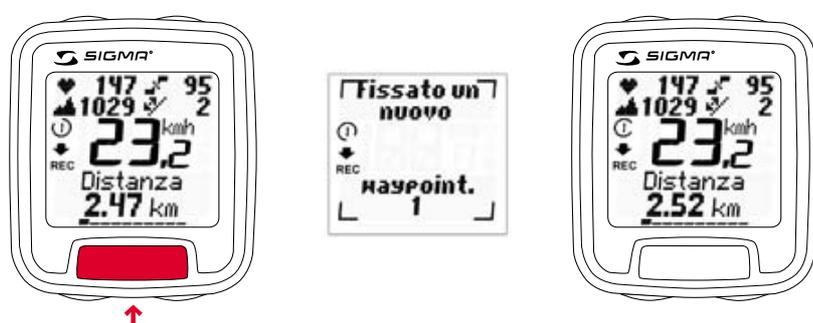
**Nota:** nell'intervallo di archivio preimpostato si può fissare solo un punto d'interesse (salvataggio ogni 5, 10, 20 e 30 secondi). Se si prova a fissare un secondo punto
