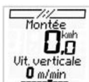
Cette fonction indique la vitesse verticale actuelle en mètres par minute. Le temps nécessaire jusqu'au sommet peut ainsi rapidement être calculé. Il s'agit ici d'une fonction actuelle, similaire à la vitesse.
