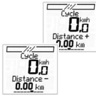
Il s'agit ici de deux compteurs séparés pour les distances parcourues (Distance +/Distance -). Ceux-ci permettent un entraînement par intervalle ou un circuit suivant un carnet de route. Ces deux compteurs peuvent être préprogrammés et remis à zéro individuellement.
