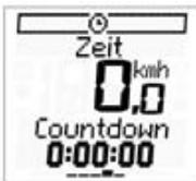
Die Stoppuhr wird mit den oberen rechten Tasten gestartet bzw. gestoppt. Mit der linken Taste können Sie die Stoppuhr auf 0 zurücksetzen. Die Stoppuhr läuft unabhängig von der Fahrzeit und muss deswegen manuell gestartet bzw. gestoppt werden.
