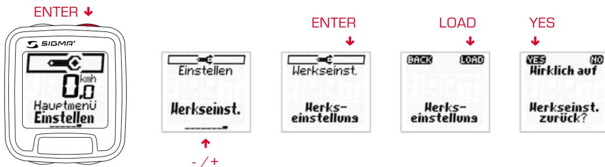
Nachdem der SIGMA ROX 9.0 auf Werkseinstellung zurückgesetzt wurde, kehrt der Fahrradcomputer in den Tiefschlafmodus zurück.
