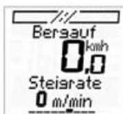
Die Steigrate zeigt Ihnen die vertikale, aktuelle Geschwindigkeit in Meter pro Minute an. So können Sie schnell errechnen, welche Zeit Sie bis zum Gipfel benötigen. Es handelt sich hier um eine aktuelle Funktion, ähnlich der Geschwindigkeit.
