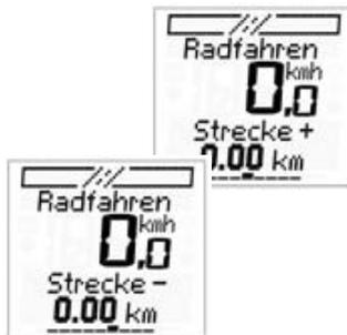
Es handelt sich hier um 2 separate Streckenzähler (Strecke+/Strecke-). Diese ermöglichen ein Intervalltraining oder eine Fahrt nach Roadbook. Beide sind vorprogrammierbar und separat zurück zu setzen.
