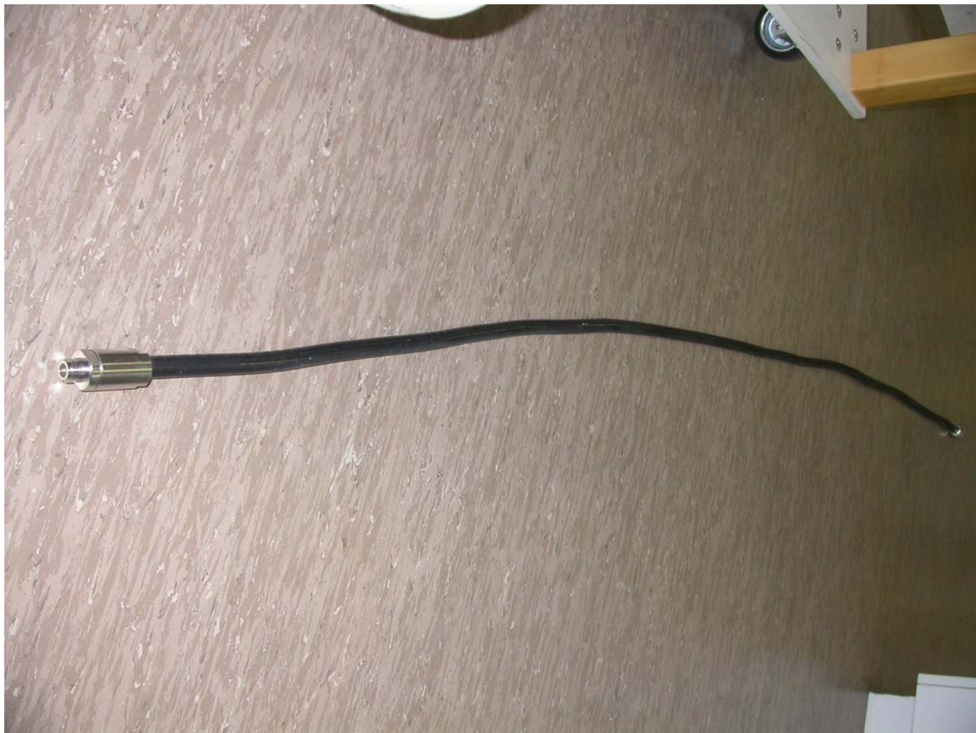
Antenna IWLAN Rcoax PE 1/2" 5 GHz
