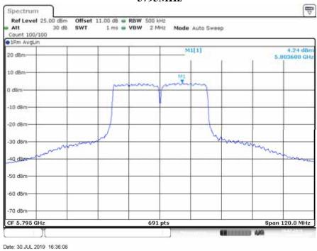
IEEE 802.11ac VHT40 Mode / 5725 ~ 5850MHz (chain 3) 5755MHz
