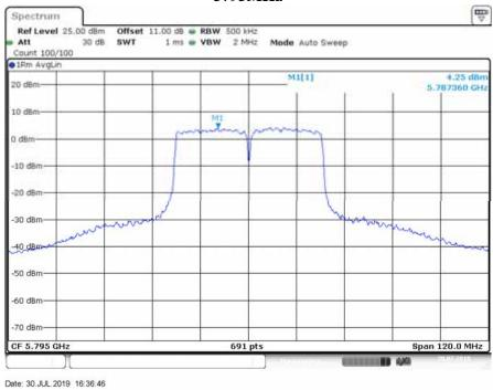
IEEE 802.11ac VHT40 Mode / 5725 ~ 5850MHz (chain 1) 5755MHz
