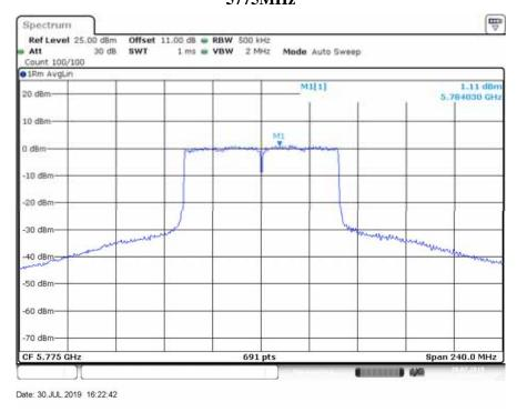
IEEE 802.11ac VHT80 Mode / 5725 ~ 5850MHz (chain 3) 5775MHz
