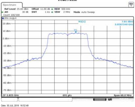
IEEE 802.11ac VHT40 Mode / 5725 ~ 5850MHz (chain 0) 5755MHz
