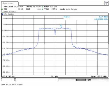
IEEE 802.11ac VHT80 Mode / 5725 ~ 5850MHz (chain 0) 5775MHz
