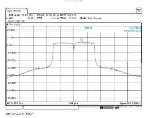
IEEE 802.11ac VHT40 Mode / 5725 ~ 5850MHz (chain 2) 5755MHz
