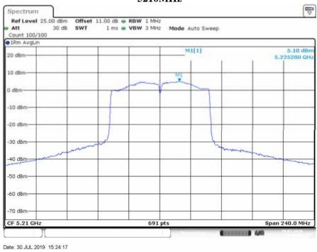
IEEE 802.11ac VHT80 Mode / 5150 ~ 5250MHz (chain 1) 5210MHz
