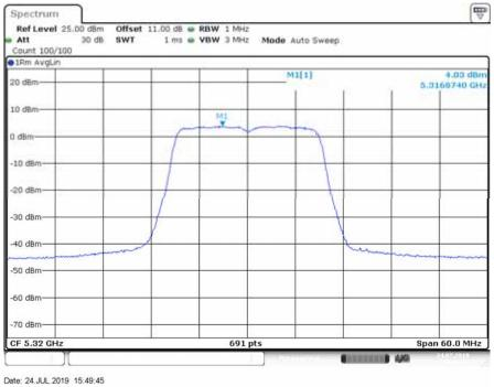
IEEE 802.11ac VHT40 Mode / 5250 ~ 5350MHz (chain 0) 5270MHz
