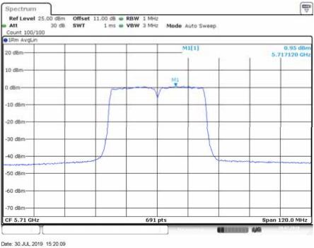
IEEE 802.11ac VHT40 Mode / 5250 ~ 5350MHz (chain 1) 5510MHz
