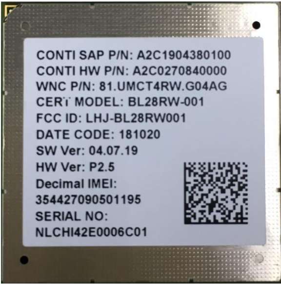
Fig. 1 BL28RW-001 module top view
