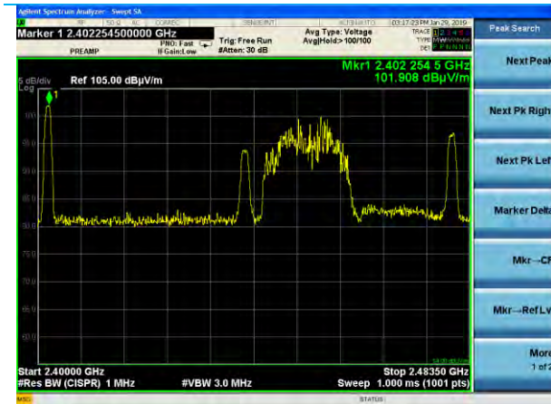
2.4-2.4835 GHz, 30dB Att. Horizontal pol.
