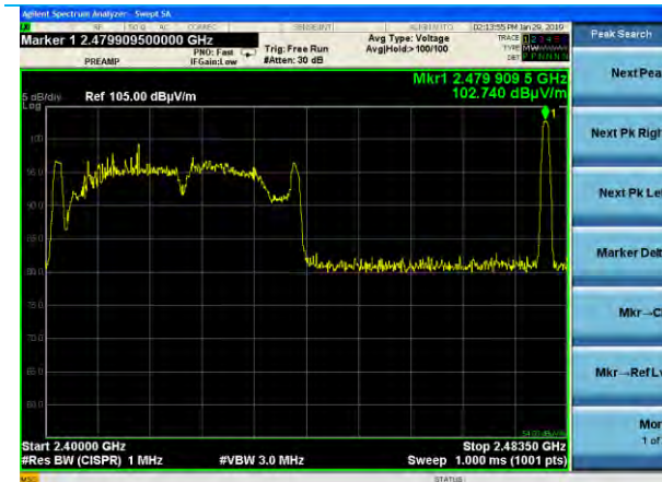
2.4-2.4835 GHz, 30dB Att. Horizontal pol.
