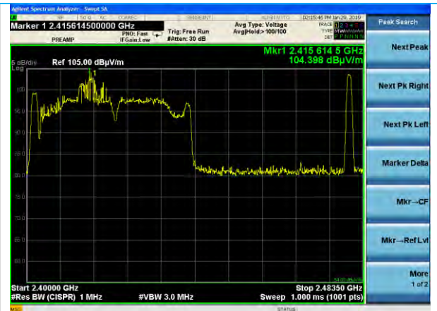
2.4-2.4835 GHz, 30dB Att. Vertical pol.
