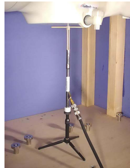
900MHz Dipole Setup
