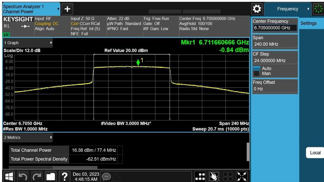
6705 MHz: HE80 Beam Forming, M0 to M11 1ss – Antenna B
