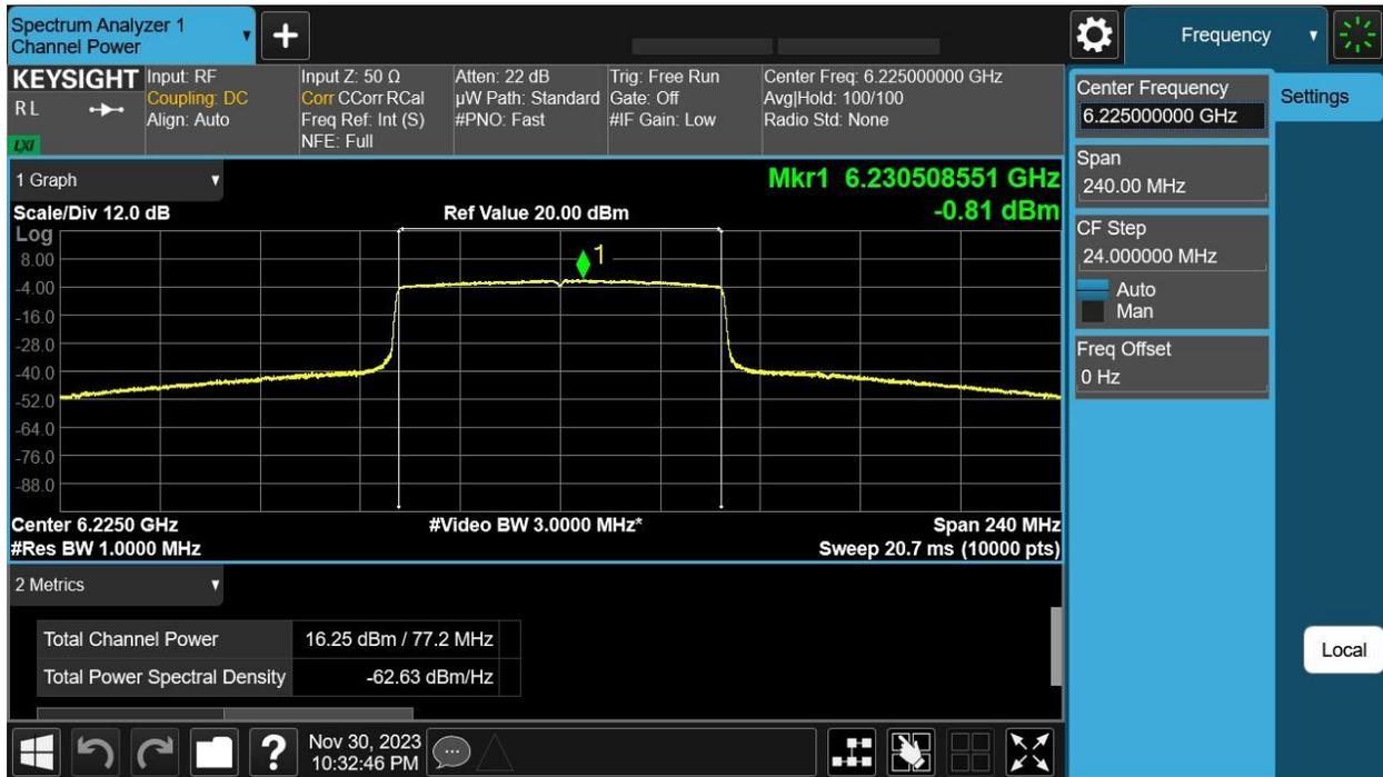
6225 MHz: HE80 Beam Forming, M0 to M11 1ss – Antenna B
