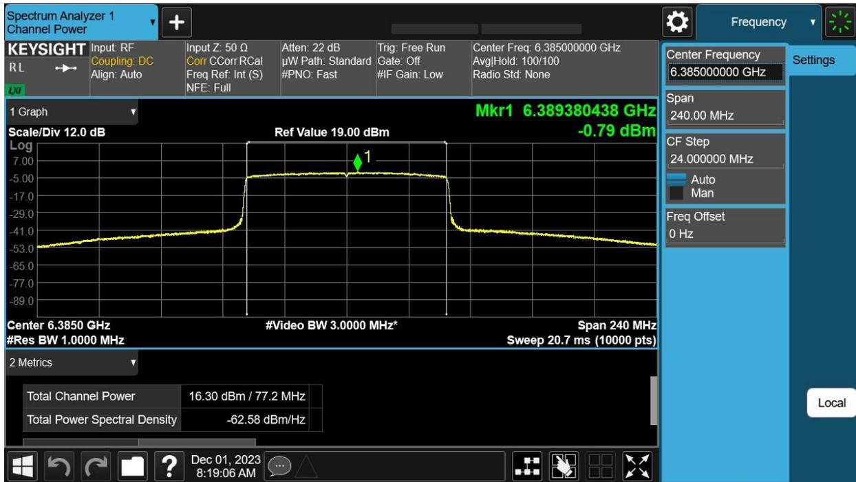
6385 MHz: HE80 Beam Forming, M0 to M11 1ss – Antenna B
