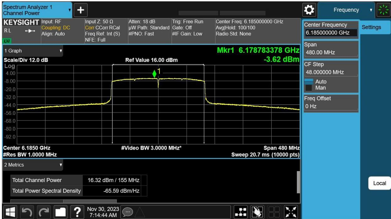
6185 MHz: HE160 Beam Forming, M0 to M11 1ss – Antenna B
