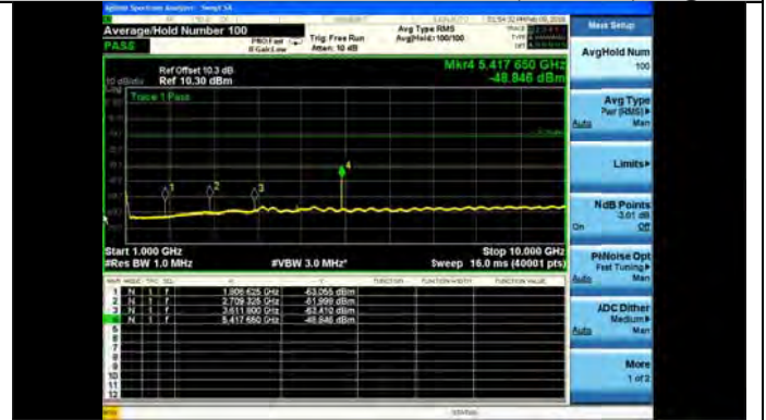
Mod: OFDM, Mode 144, 914.8MHz (1-10GHz) Avg
