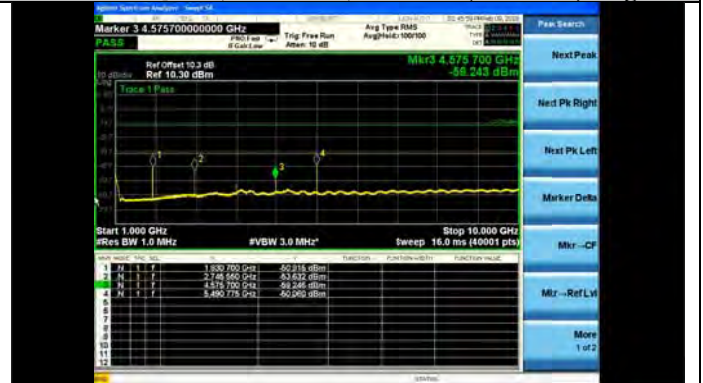
Mod: OQPSK, Mode 192, 927.8MHz (1-10GHz) Avg
