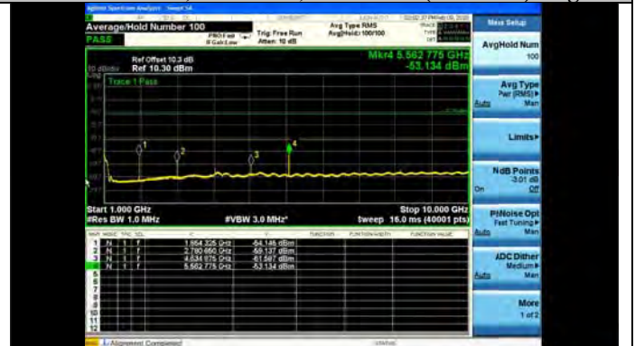
Mod: OFDM, Mode 144, 926.8MHz (1-10GHz) Avg
