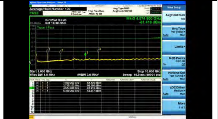
Mod: OFDM, Mode 144, 926.8MHz (1-10GHz) Avg
