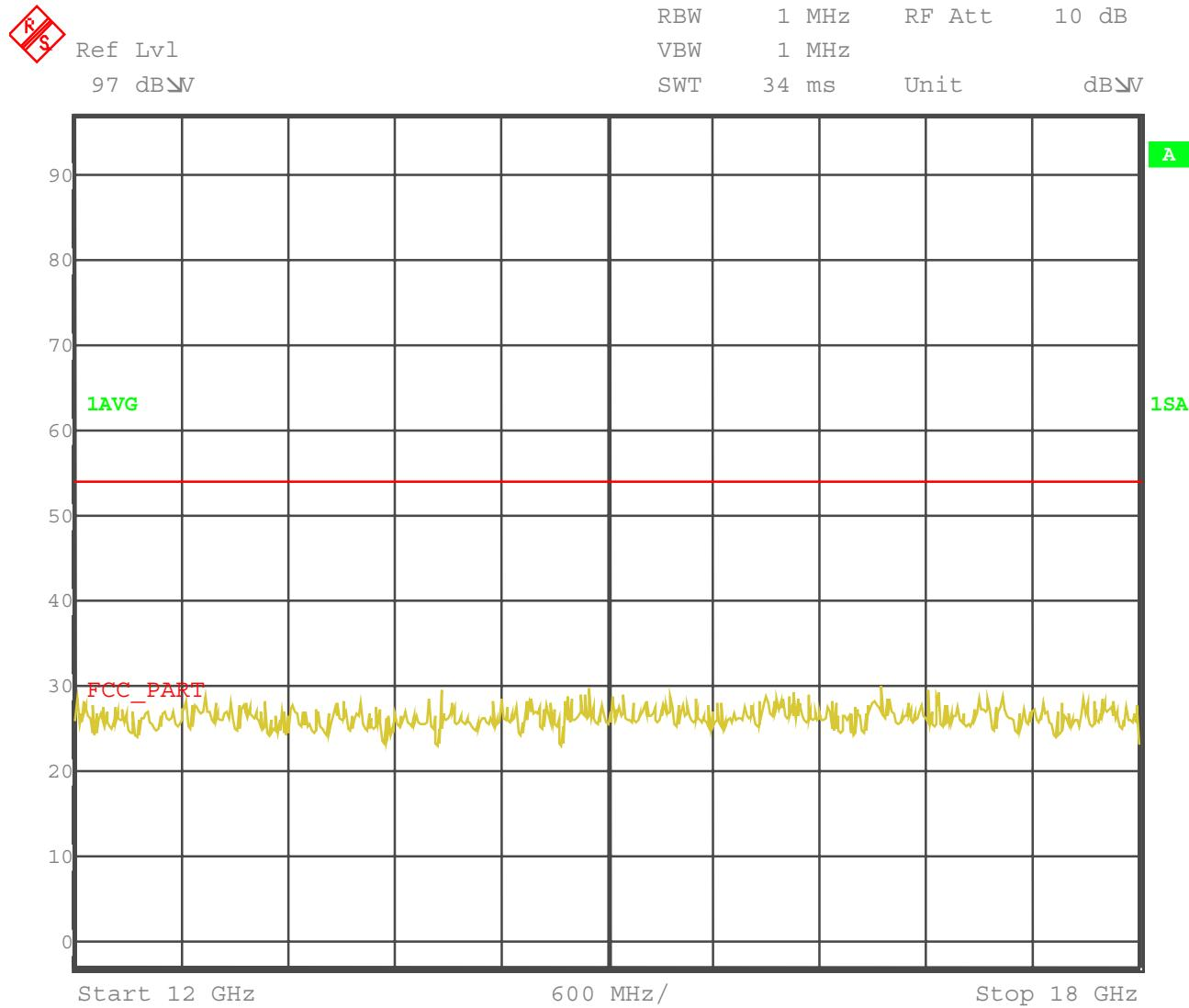
$f < 1$  GHz : RBW/VBW: 100 kHz $f \geq 1$  GHz : RBW/VBW: 1 MHz
