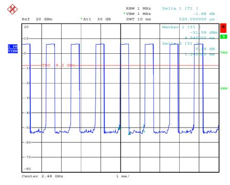
DH1 Modulation Type: GFSK (Channel 78) :
