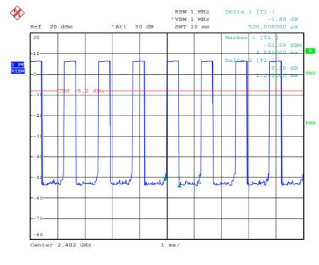
DH1 Modulation Type: GFSK (Channel 00) :
