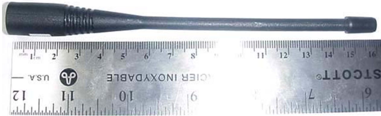
Detachable Whip Antenna (P/N: KAA0815)
