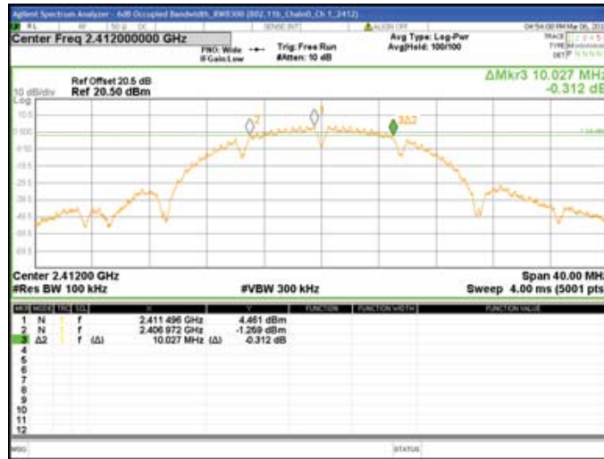
Chain0 : 6dB Bandwidth @ 802.11b Mode Ch 6
