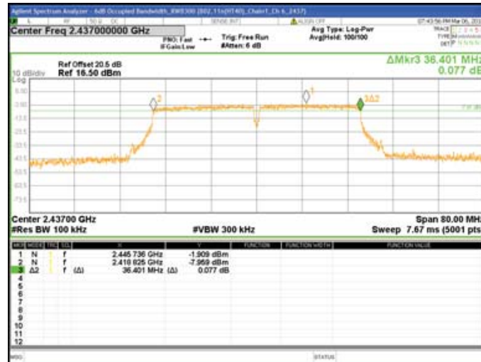
Chain1 : 6dB Bandwidth @ 802.11n(HT40) Mode Ch 9
