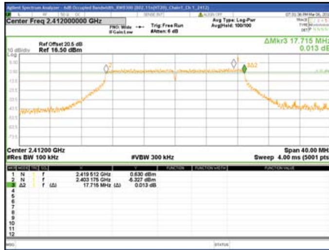
Chain1 : 6dB Bandwidth @ 802.11n(HT20) Mode Ch 6
