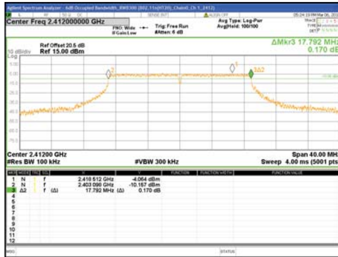
Chain0 : 6dB Bandwidth @ 802.11n(HT20) Mode Ch 6
