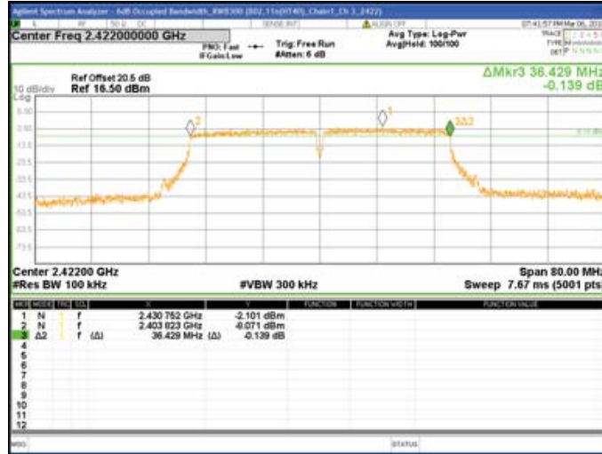
Chain1 : 6dB Bandwidth @ 802.11n(HT40) Mode Ch 6
