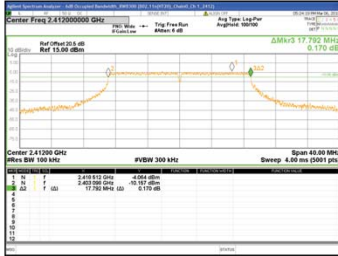
Chain0 : 6dB Bandwidth @ 802.11n(HT20) Mode Ch 6
