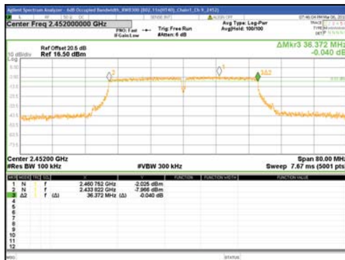
Chain1 : 6dB Bandwidth @ 802.11n(HT40) Mode Ch 9
