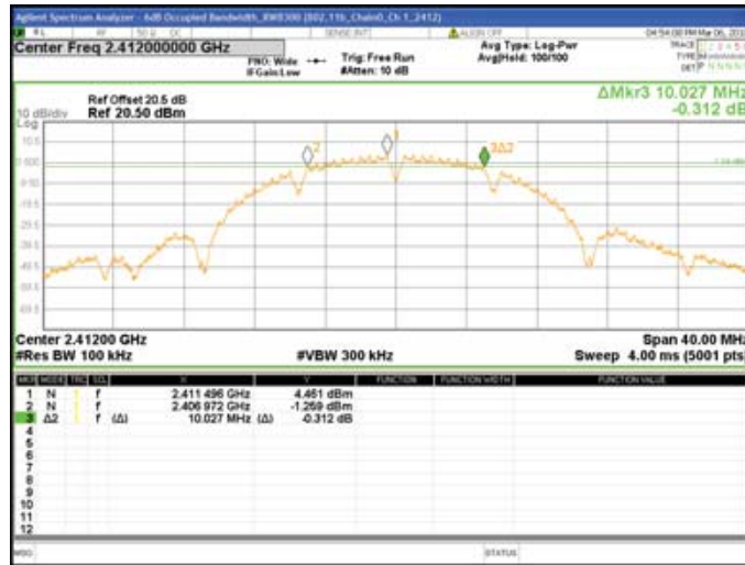
Chain0 : 6dB Bandwidth @ 802.11b Mode Ch 6
