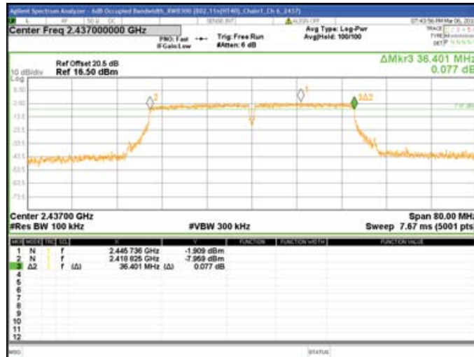
Chain1 : 6dB Bandwidth @ 802.11n(HT40) Mode Ch 9
