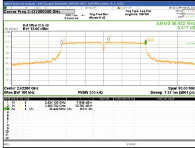
Chain0 : 6dB Bandwidth @ 802.11n(HT40) Mode Ch 6
