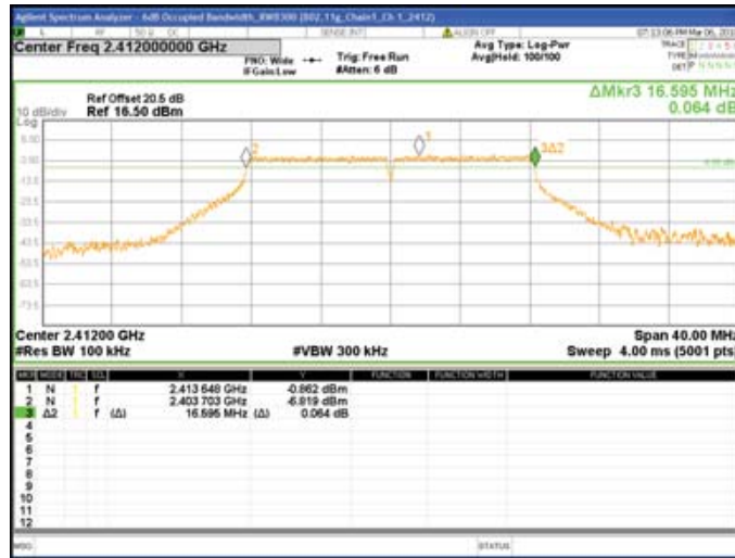
Chain1 : 6dB Bandwidth @ 802.11g Mode Ch 6
