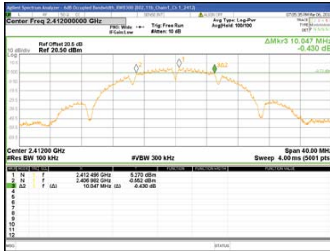
Chain1 : 6dB Bandwidth @ 802.11b Mode Ch 6
