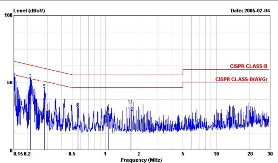
Site : CO01-LK Condition : CISPR CLASS-B CO01 LISN 93-08-30 LINE EUT : 4/1 port Router MODEL : F5D5231-4 PONUMC
