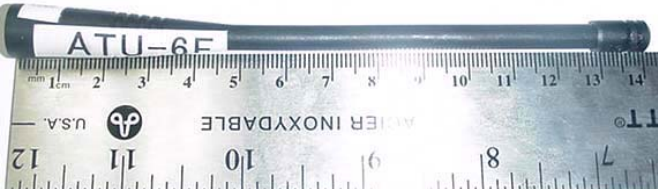
Whip Antenna P/N: ATU-6F (485-512 MHz)
