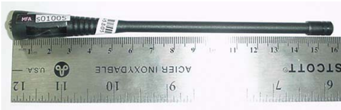
Whip Antenna (P/N: ATU-5F)
