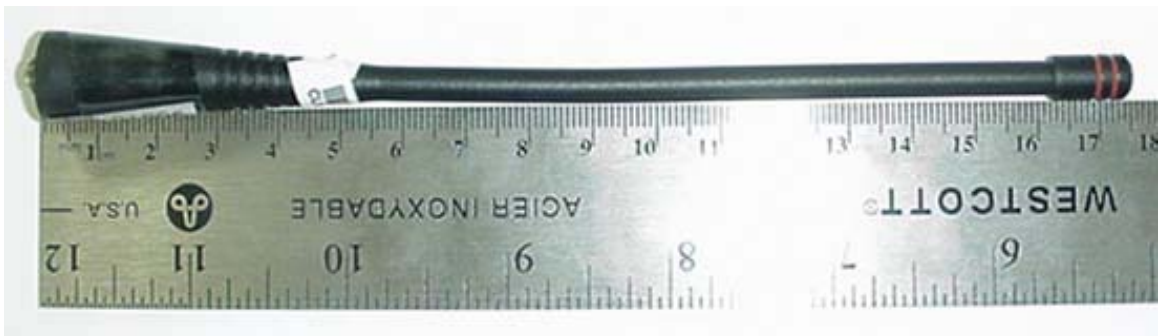
Whip Antenna (P/N: ATU-5D)
