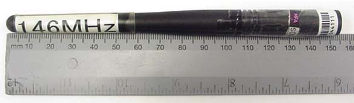
146 MHz Whip Antenna (P/N: ATV-8A)
