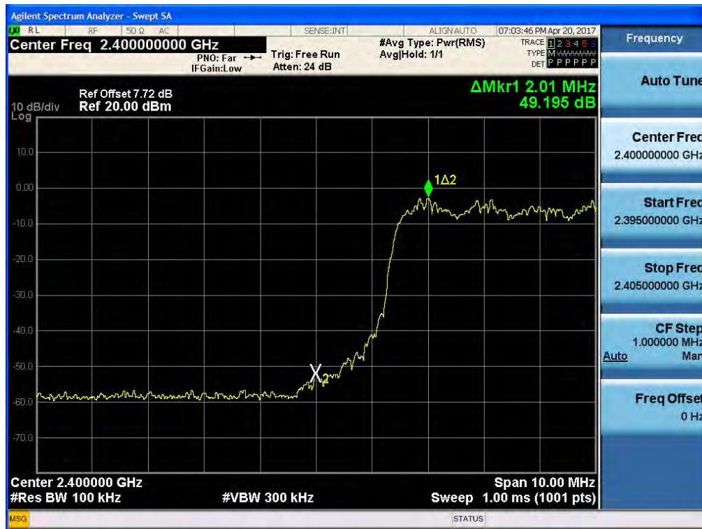
Test Plots with hopping ( $\pi/4$ DQPSK)
