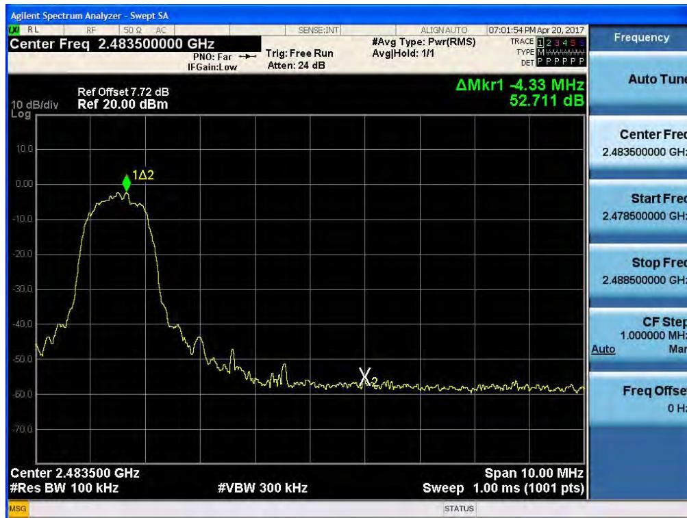
Test Plots without hopping ( $\pi/4$ DQPSK)
