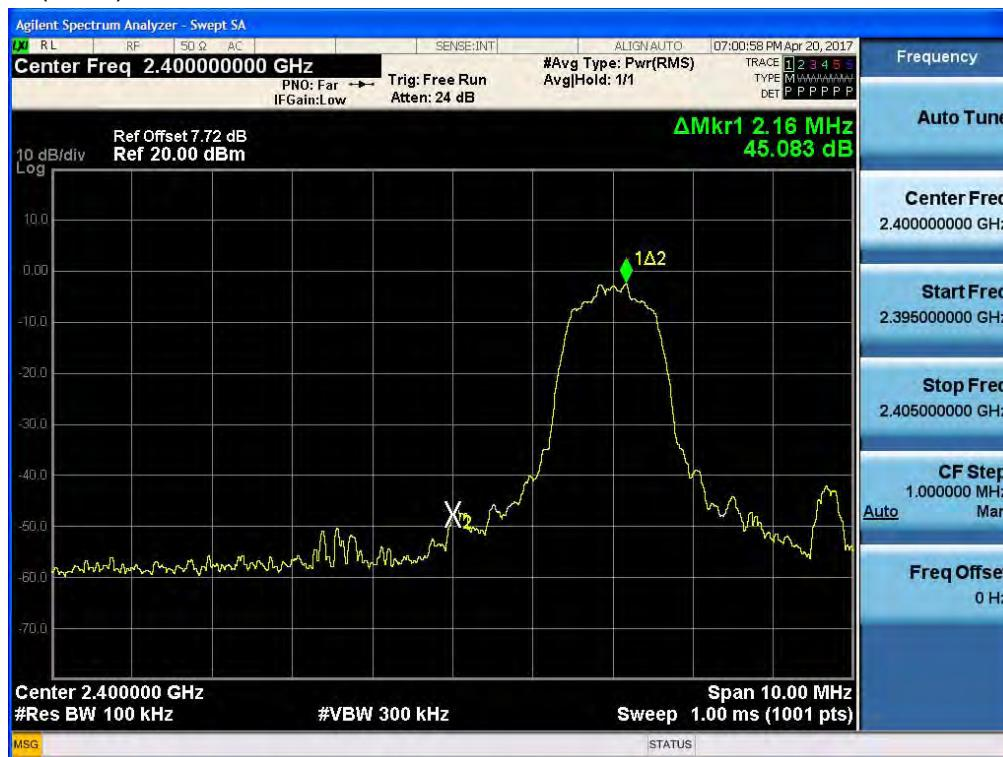
Test Plots without hopping ( $\pi/4$ DQPSK)
