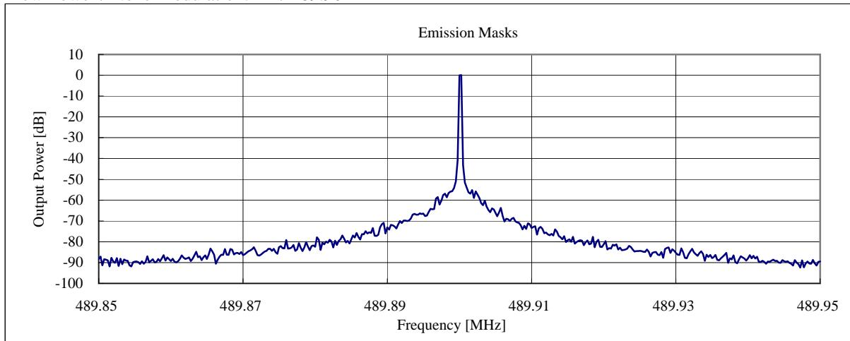
State : Low Power / Narrow Band Modulation:FM / 489.90 MHz
