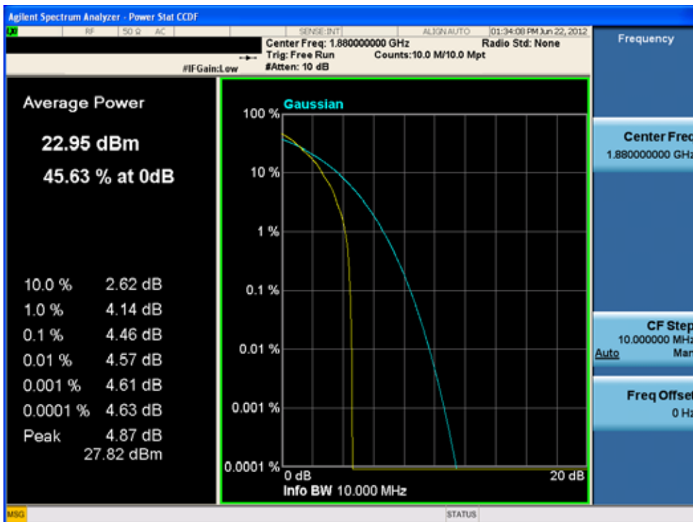
PAR Plot (10MHz QPSK - RB Size 1)
