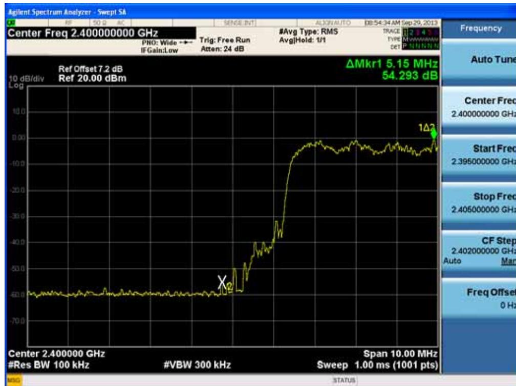
Test Plots with hopping ( $\pi/4$ DQPSK)
