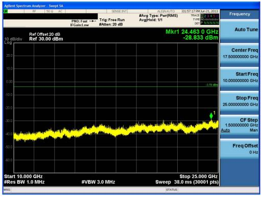
Test Plots ( $\pi$ /4DQPSK) - 10 GHz - 25 GHz Spurious Emission (Mid-CH)
