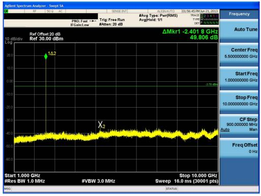
Test Plots ( $\pi$ /4DQPSK) - 1 GHz - 10 GHz Spurious Emission (Mid-CH)
