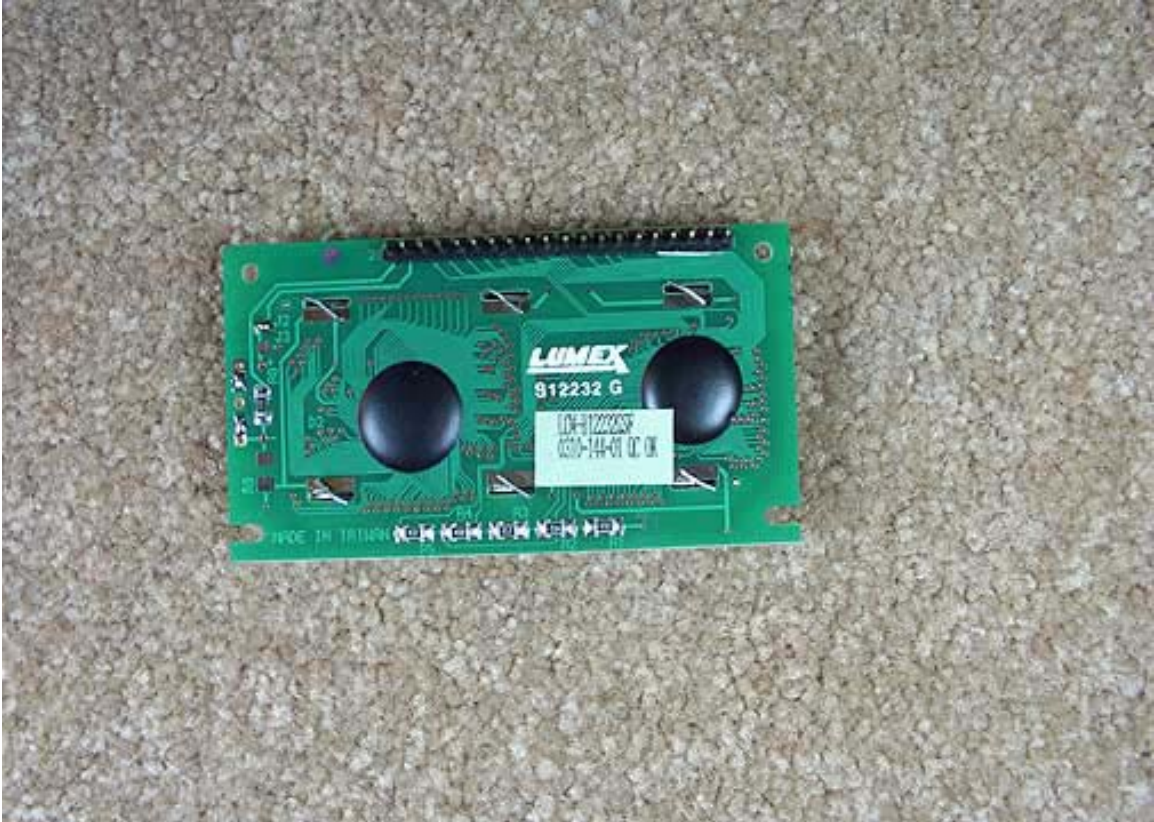
Display PCB Bottom
