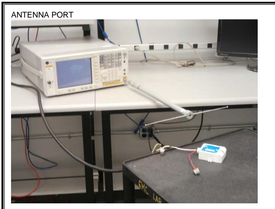
**RADIATED EMISSION FOR PORTABLE CONFIGURATION – WORST CASE ORIENTATION**
